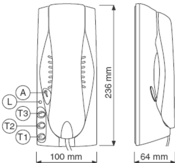
A – tlačítko pro otevření el. zámku
